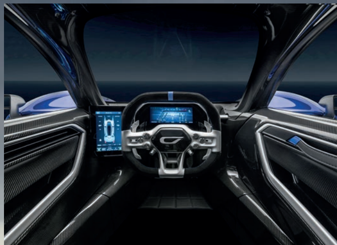
Pozici řidiče v podélné ose vozu připomíná Czinger legendární McLaren F1 z devadesátek. Palubní funkce se ovládají buď na tabletu, nebo na hranatém volantu, který jako by si odskočil ze závodáku.
