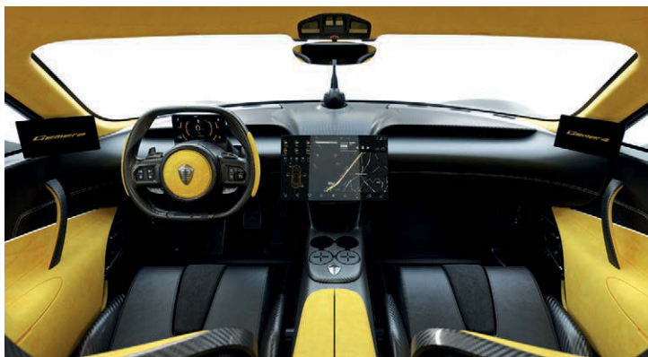
Jako první model značky postrádá gamera zpětná zrcátka. Místo nich má aerodynamičtější kamery s výstupem na dvě obrazovky umístěné v rozích palubní desky.
