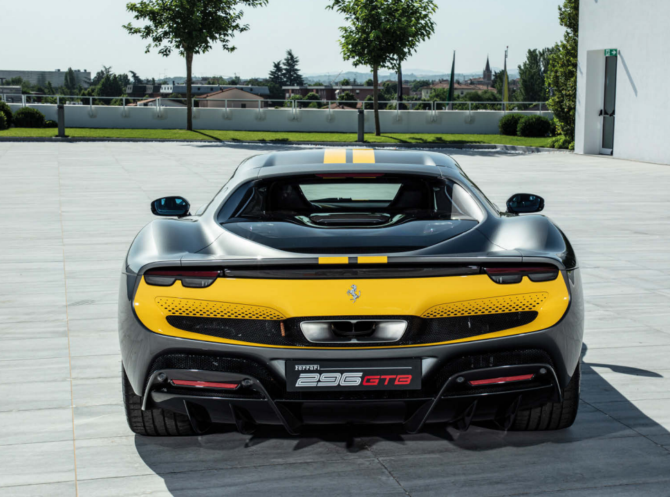
Aktivní aerodynamické prvky vytvářejí přítlak až 360 kg. Kruhové výfuky jsou minulostí.
