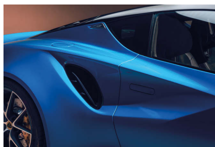
Každý záhyb na elegantní karoserii má jasnou funkci. Kapsy na bocích vedou vzduch k motoru, prolisy v kapotě zvyšují přítlak.
