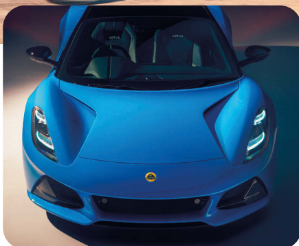
Každý záhyb na elegantní karoserii má jasnou funkci. Kapsy na bocích vedou vzduch k motoru, prolisy v kapotě zvyšují přítlak.
