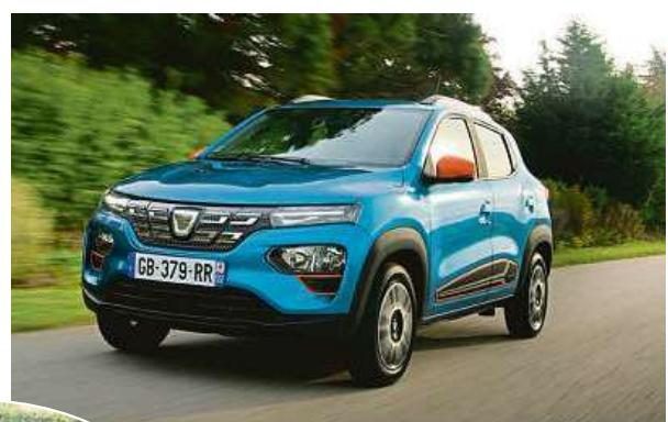
(ekvivalent 44 koní), který je s p o j e n s trakčním akumulátorem o kapacitě 27,4 kWh. Spokojit se však musíte s akcelerací 0–100 km/h za 19,1 s a omezeným vnitřním prostorem. Zatímco kufr nabídne v dané kategorii minivozů slušných 290 litrů, co do šířky se budou 4 dospělí cítit přece jen stísněné, a po- pravdě pokud si vyrazí dva
